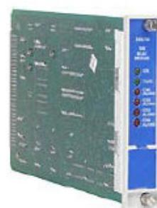
Релейный модуль 3500/34 TMR работает совместно со специальным системным TMR-модулем и тройными группами мониторов, обеспечивая резервирование по логике 2 из 3-х. Реле защищены эпоксидной смолой и содержат искро-защиту. Реле могут быть запрограммированы на работу какnormally запитанными, так и normally незапитанными.
