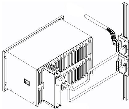
Блоки внешнего подключения, к которым подсоединяются полевые кабели, установлены на DIN-рейке и подсоединенены к модулям ввода/ вывода 3500 кабелями.
