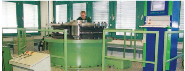
Испытательный стенд для 250 кНм
