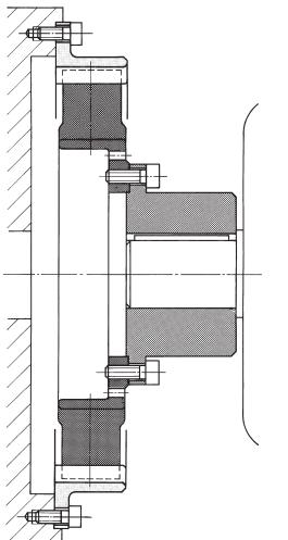
Этот конструктивный ряд применяется преимущественно для больших агрегатов. Обозначение SDE означает муфты с двумя элементами и применяется для типоразмеров 4000 SDE, 8000 SDE, 12000 SDE и 18000 SDE.
