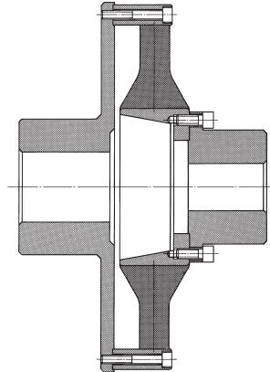
Только в размере 8000 SDEW со сдвоенным элементом применяется соответствующее внешнее алюминиевое кольцо (как SAE 18).
